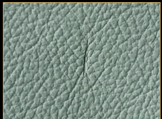
Prasklina nebo řez - bodnutí nožem na líci zastříkané úpravou
